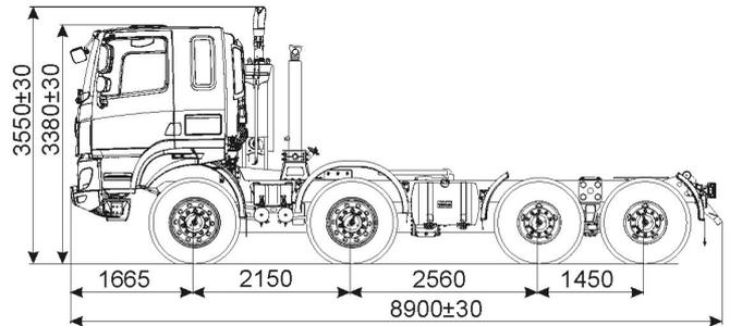
Die Höhenabmessungen sind für das beladene Fahrzeug gültig.
