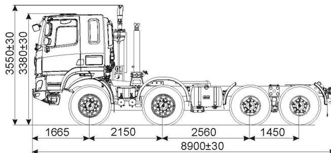
Die Höhenabmessungen sind für das beladene Fahrzeug gültig.
